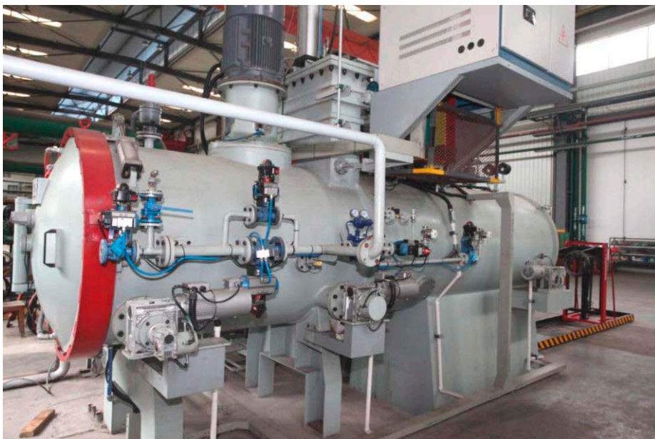
Рисунок 4 – Вакуумная печь VFIA 4466 OG88 для закалки в инертном газе и масле [6]
